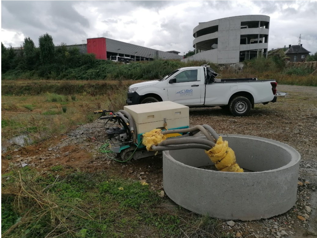
Foto 1: Durchführung des Geothermal Response Test an EWS 1
