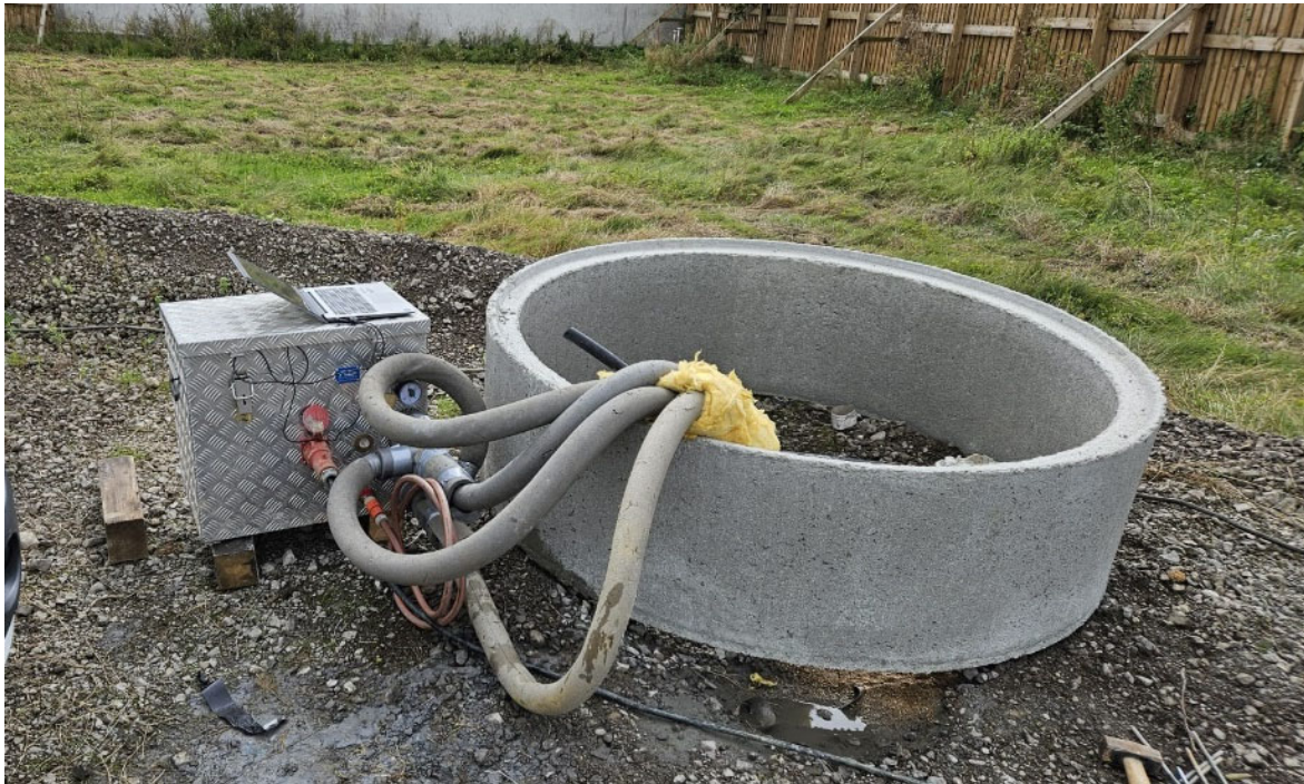
Foto 5: Durchführung des Geothermal Response Test an EWS 3
