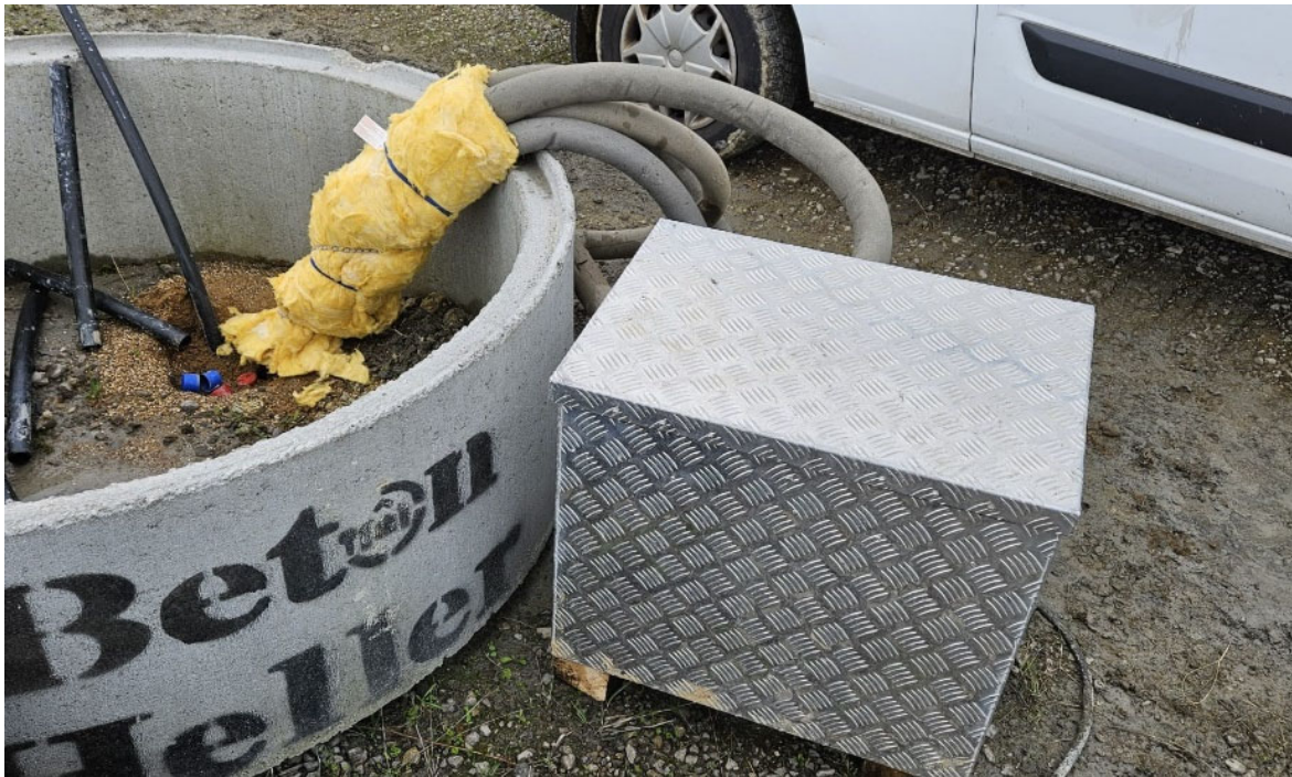
Foto 3: Durchführung des Geothermal Response Test an EWS 2
