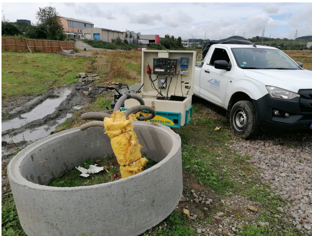
Foto 7: Durchführung des Geothermal Response Test an EWS 4
